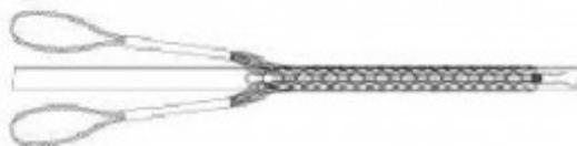
Поддерживающий разъемный кабельный чулок с двумя петлями предназначен для подвеса кабеля или провода в любом месте на всем его протяжении на кронштейны при проведении работ по монтажу кабеля. Оснащен двумя петлями для подвеса. Изготовлен из стального оцинкованного троса.
