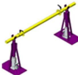
**Кабельный домкрат гидравлический ДГ 2** предназначен для подъема и размотки кабельных барабанов диаметром 800-1600 мм и массой до 2000 кг. Комплект состоит из двух стоек с домкратами и оси диаметром 40 мм. Подъем осуществляется с помощью гидравлических домкратов. Может использоваться в качестве отдающей/подающей стойки при проведении отмоток кабеля, провода, троса и т.д.
