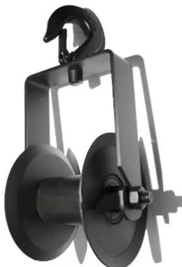
Ролик монтажный подвесной **РВ 2000М** предназначен для протяжки кабеля при монтаже воздушных кабельных линий. Ролик кабельный подвесной имеет удобные для крепления крюки, позволяющие быстро закрепить ролик на направляющих элементах. Ролик оснащен шарикоподшипниками, что облегчает процесс вращения ролика. Подвес кабеля — воздушная линия связи.
