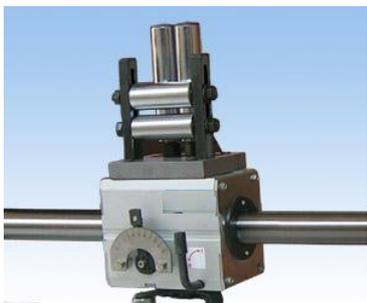
**Наименование модели:** ОКВ-Ф **Линейный привод укомплектован четырьмя направляющими металлическими роликами** Существует 6 типов, в зависимости от диаметра вала: ОКВ15-F, ОКВ20-F, ОКВ30-F, ОКВ40-F, ОКВ50-F, ОКВ60-F. Подходит для намотки электропровода, кабеля
