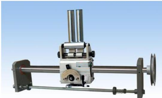
**Наименование модели: ОКС-Т**Линейный привод укомплектован тремя направляющими металлическими роликами, валом, стойками Существует 6 типов, в зависимости от диаметра вала: ОКС15-Т, ОКС20-Т, ОКС30-Т, ОКС40-Т, ОКС50-Т, ОКС60-Т.
