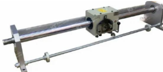
Линейный привод – ОКRS – замена системы винта гайка (ШВП). Преимущества: гладкий вал исключает застопоривание привода, вследствие засорения, замятия дорожек. При постоянном движении вала имеет право-и левосторонний ход. Не требует применения серводвигателей, контроллеров. В отличие от системы винт-гайка, позволяет менять скорость движения привода (шаг раскладки) не меняя скорости двигателя.
