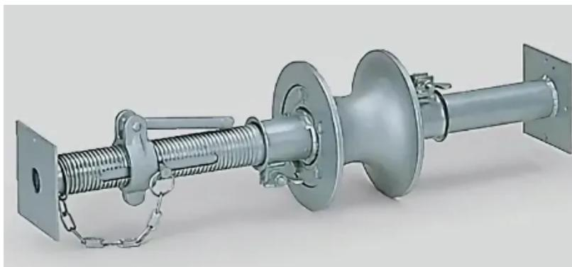
**Ролик кабельный линейный на штанге – ZR 220** предназначен для протяжки кабеля и труб диаметром до 120мм. Штанга устанавливается в технологических проемах. Оператор, совершая вращательные движения концевой пластины осуществляет разжим штанги, при достижении необходимой длины штанги, при помощи ручки и скрытой внутренней гайки распор штанги «дожимается», что обеспечивает жесткую фиксацию штанги в проеме. При необходимости ручка, совмещенная с гайкой снимается.
