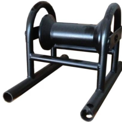
Ролик монтажный линейный **РКЛ-1** предназначен для протяжки кабеля диаметром до 150мм при монтаже кабельных линий на прямых участках трассы. Ролик оснащен двумя подшипниками для облегчения процесса вращения ролика. Основание ролика имеет специальные стяжки, что позволяет установить ролик сверху на кабель для протяжки кабеля в два уровня.
