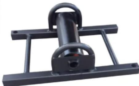
Ролик кабельный линейный **РП-50У** предназначен для протяжки кабеля при монтаже кабельных линий. Благодаря использованию роликов для прокладки кабеля (кабельных роликов) уменьшается сопротивление при протяжке и исключается возможность повреждения кабеля. Ролик имеет небольшую высоту, всего 110мм, что позволяет осуществлять протяжку кабеля в лотках и траншеях ограниченных по высоте.
