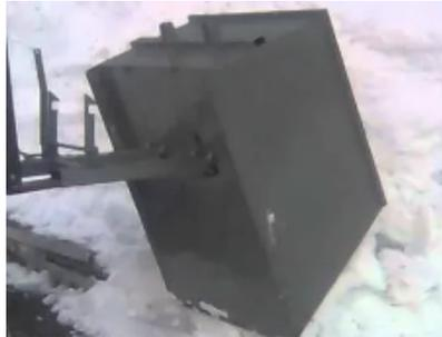
Совок механический **СБ 1.5-15П** предназначен для уборки и транспортировки снега и прочих сыпучих материалов с автоматической выгрузкой.
