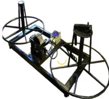
Станок перемоточный **СП 0,5-30-P** предназначен для перемотки кабеля, провода, троса диаметром 3-20 мм с одновременным измерением длины с бухты на бухту диаметром до 500 мм.
