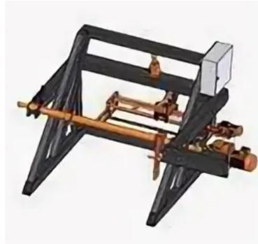
**Станок намоточный универсальный СП 14-1У** предназначен для проведения отмоток кабеля, провода, троса диаметром 5-65 мм с одновременным измерением длины на кабельные барабаны диаметром 800-1400 мм (№8-14) и массой до 1000 кг, и в бухты диаметром 600-1000 мм и массой до 300 кг. Может комплектоваться ручным или автоматическим раскладчиком.
