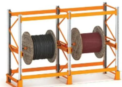
**Стеллаж кабельный СКБ 3,8-6** предназначен для хранения кабельных барабанов диаметром 800- 1700 мм (№№ 8-17) и массой до 4000 кг на нижнем ярусе, до 2000 кг на среднем ярусе и до 1000 кг на верхнем ярусе. Суммарная грузоподъемность на пролёт составляет 7000 кг.
