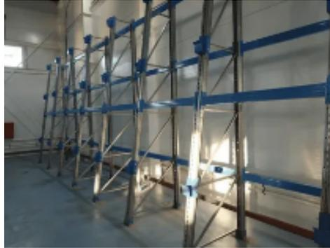
Стеллаж кабельный СКБ 4,2-ЗП предназначен для хранения кабельных барабанов диаметром 800-1220 мм (№№ 8-12) и массой до 1000 кг. Суммарная грузоподъёмность на пролёт составляет 3000 кг.
