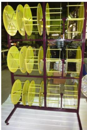
**Стойка распределительная СР 12М** предназначена для размотки и хранения бухт кабельных бухт диаметром до 500 мм и массой до 30 кг. Может использоваться в качестве отдающей/подающей стойки при перемотке кабеля, провода, троса и т.д.
