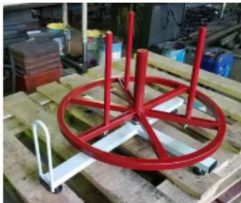
Стойка предназначена для размотки бухт кабеля диаметром до 700мм и массой до 150кг.
