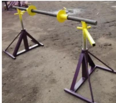
Стойка размотки кабельных барабанов **СП 1-0,2** – предназначена для смотки кабельно-проводниковой продукции с барабанов до 10-го типоразмера, массой до 200 кг. В комплект входит: 2 стойки, ось диаметром 40 мм. Диаметр поднимаемых барабанов 800...1000 мм.
