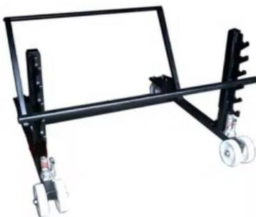
Телега кабельная (для кабельных барабанов) Т 16-2 предназначена для подъема с пола и транспортировки кабельных барабанов диаметром 1000...1600 мм и массой до 2000 кг.
