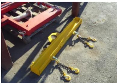
Траверса навесная для аккумуляторных батарей **ТАБ 8** предназначена для перемещения аккумуляторных батарей массой не более 800 кг, а также прочих грузов, соответствующих по массе и габаритам, допустимым для изделия величинам.
