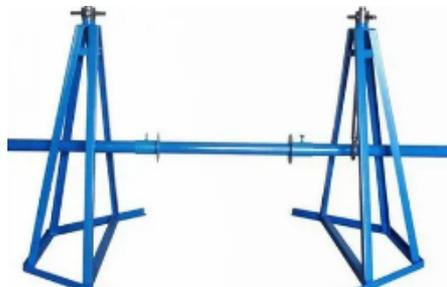
**Кабельный домкрат винтовой ДВ 1** – предназначен для удержания на весу и смотки кабельно-проводниковой продукции с кабельных барабанов с 8-го до 10-го типоразмера (D 8000...1000мм), массой до 1000 кг. В комплект входит: 2 стойки, ось (карандаш) диаметром 40мм с поджимными башмаками, винтовая пара.
