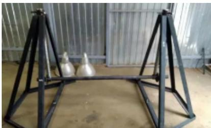
**Кабельный домкрат УСИЛЕННЫЙ ВИНТОВОЙ ДК-5М1** предназначен для подъема и размотки кабельных барабанов диаметром 1000-2200 мм и массой до 6000 кг. Комплект состоит из двух стоек с винтами и оси диаметром 60мм длиной 2000мм с поджимными башмаками. Подъем осуществляется с помощью винтовой пары. Может использоваться в качестве отдающей/подающей стойки при проведении отмоток кабеля, провода, троса и т.д.
