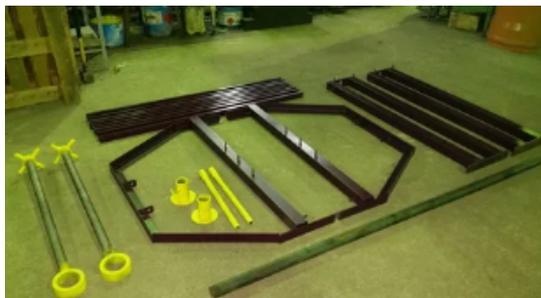
**Домкрат кабельный ДК-5ВР серии Атлант винтовой разборный-** это грузоподъемное устройство для подъема и размотки кабельных барабанов с 8 по 22 типоразмер. Грузоподъемность кабельного домкрата 5 тонн. **Комплектация:** две стойки, ось цельнометаллическая 48x1700мм с поджимными башмаками.
