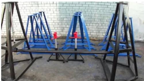
**Кабельный домкрат ДК-5В** предназначен для подъема и размотки кабельных барабанов диаметром 800-2200 мм и массой до 5000 кг. Комплект состоит из двух стоек с цельнометаллическими винтами и осью диаметром 48 мм с поджимными башмаками. Подъем осуществляется с помощью винтовой пары. Может использоваться в качестве отдающей/подающей стойки при проведении отмоток кабеля, провода, троса и т.д.
