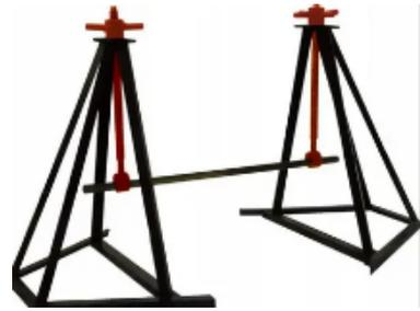
**Кабельный домкрат ДК-5ВМ** предназначен для подъёма и размотки кабельных барабанов диаметром 800-2200 мм и массой до 5000 кг. Комплект состоит из двух стоек с винтами и оси диаметром 48 мм с поджимными башмаками. В винты вварены мощные подшипники для облегчения процесса вращения барабана на оси. Подъём осуществляется с помощью винтовой пары. Может использоваться в качестве отдающей/подающей стойки при проведении отмоток кабеля, провода, троса и т.д.
