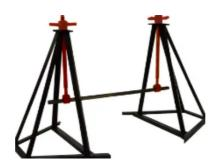
**Кабельный домкрат ДВ 8** предназначен для подъёма и размотки кабельных барабанов диаметром 800-2200 мм и массой до 8000 кг. Комплект состоит из двух стоек с домкратами и кабельных осей диаметром 48мм и 70мм с поджимными башмаками. Подъём осуществляется с помощью винтовой пары. Может использоваться в качестве отдающей/ подающей стойки при проведении отмоток кабеля, провода, троса и т.д.
